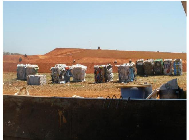
*Figura 7.11 – Material reciclável prensado e separado*
